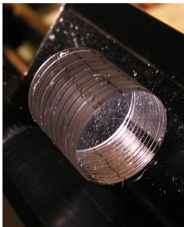
Obrázek 2: Dvojlomný interferenčně polarizační filtru Šolcova typu složený z 11 destiček o tloušťce 1.8320 mm s obdélníkovitým rozdělením azimutů.
