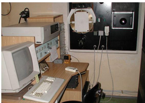
Obr. 4: Pozorovací místnost magnetografu s jeho ovládacím pultem a počítačem PP 06. Uprostřed kruhové desky v horní části obrazu, určené ke kalibraci souřadnicového systému, je vstupní štěrbiná spektrografu.
