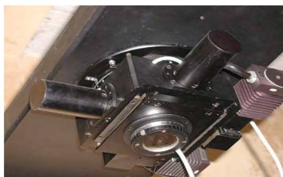
Obr.5: Srdcem řídicího systému dalekohledu a magnetografu je pointační čidlo, umístěné na tomto skanovacím stolku. Chybové signály z čidla řídí pohyb zrcadel coelostatu tak, že obraz slunečního disku se neustále nachází v jeho středu. Pohybem stolku ve dvou navzájem kolmých směrech pak můžeme obraz slunečního disku umístit do požadované polohy. Stejným způsobem se bude pohybovat obraz Slunce po vstupní štěrbině spektro-grafu. Souřadnice bodu slunečního disku na štěrbině jsou definovány polohou skanovacího stolku.
